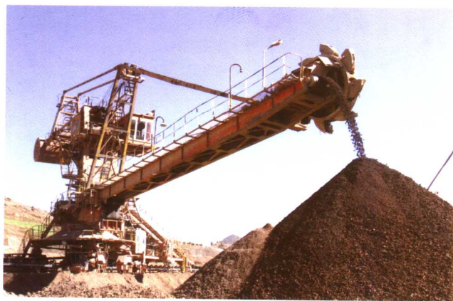
云南磷化集团生产现场3堆取料机正在作业
