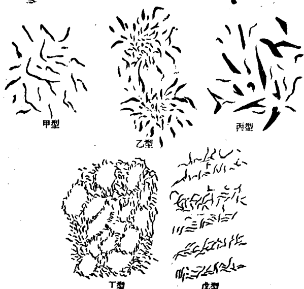
圖2 鑄鐵中石墨片分佈的五種類型。
