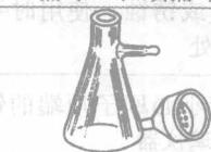
吸滤瓶和布氏漏斗                                                                                    | 两者配套使用于无机制备中晶体或沉淀的减压过滤，利用水泵或真空泵降低吸滤瓶中压力以加速过滤                                       | 不能用火直接加热           |
