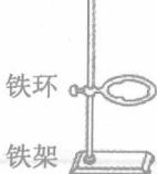
铁环                                                                                            | 用于固定或放置反应容器，铁环还可以代替漏斗架使用                                                           | 防止受潮锈蚀             |
