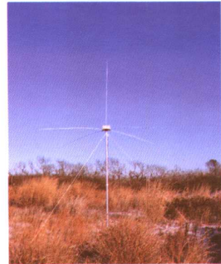
德国 CODAR 04 洋流测量 超视距雷达
