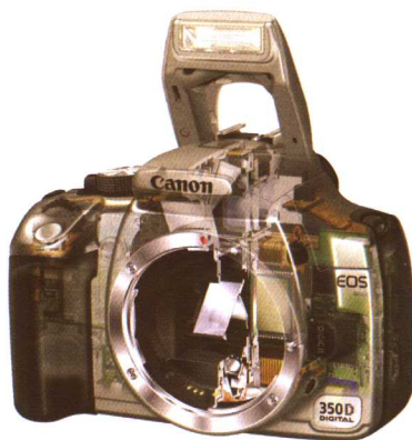
◆ 单反数码相机内部结构
