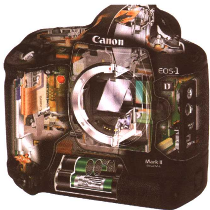
◆ 佳能1D Mark II采用了APS-H画幅CMOS图像传感器
