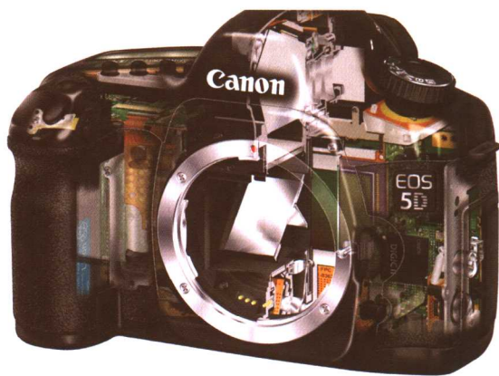
◆ 佳能EOS 5D采用了全画幅CMOS图像传感器
