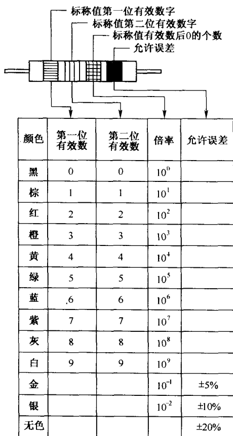
图 1-11 两位有效数字的阻值色标表示法
