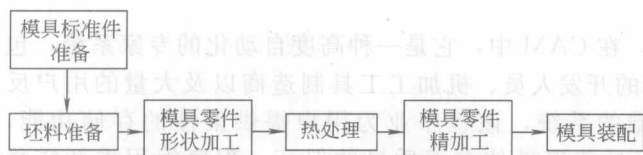
图 1-3 模具加工程序框图
