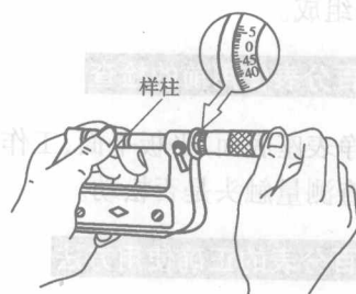
图 1-1-18 25mm 以上千分尺的零位检查
