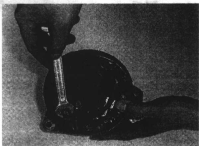
图 1-4 拆下 B + 和 E 接柱接线螺母
