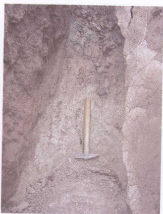
图版4-6 安乐寺滑坡底层滑带地表露头
