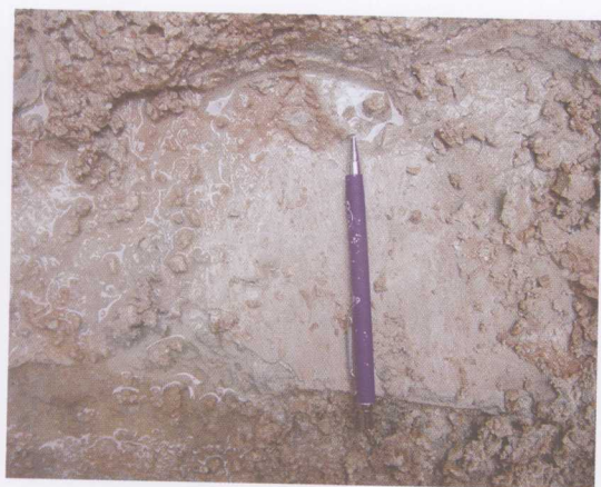
图版4-8 安乐寺滑坡底层滑带下伏基岩面上的滑动擦痕(滑动方向为 100^{\circ} )
