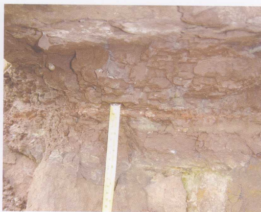
图版3-6 检察院附近软弱夹层中的剪切面
