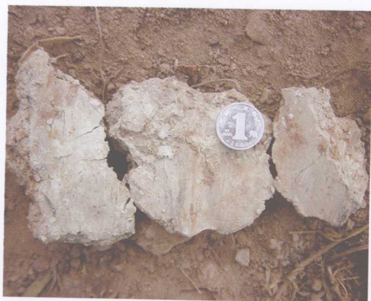
图版4-7 安乐寺滑坡底层滑带中的滑面
