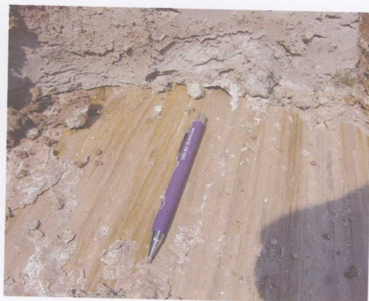
图版4-11 安乐寺滑坡第二层滑带擦痕(滑动方向为 102^{\circ} )
