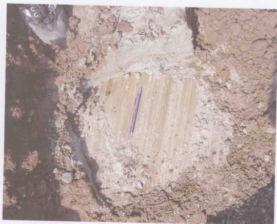
图版4-10 安乐寺滑坡第二层滑带擦痕(滑动方向为 102^{\circ} )
