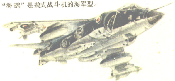
英国航宇“海鸥”世界上 最早生产的垂直起落战斗攻击机。 “海鸥”是鸥式战斗机的海军型。
