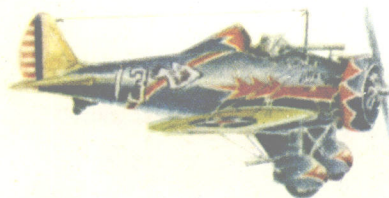
波音 P-26A（美，1933年）带有机轮整流罩和加强张线的单翼战斗机。
