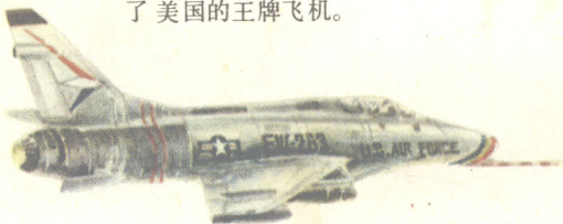
北美F-100A“超级佩刀”(美， 1953年)世界上最早的超音速喷气 战斗机，最大时速1,320公里。
