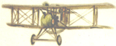
德·哈维兰 D.H. 2（英，1915年）初期的推进式飞机，机头装有一挺机枪。
