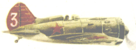
波里卡尔波夫 伊-16（苏，1933年）世界上第一架装有可收放起落架的单翼战斗机。
