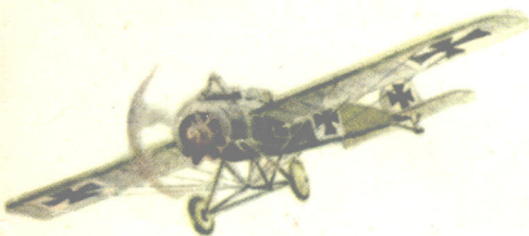
福克 E-III（德，1915年）第一种安装机枪协调器的飞机，枪弹可通过螺旋桨旋转空隙射出。
