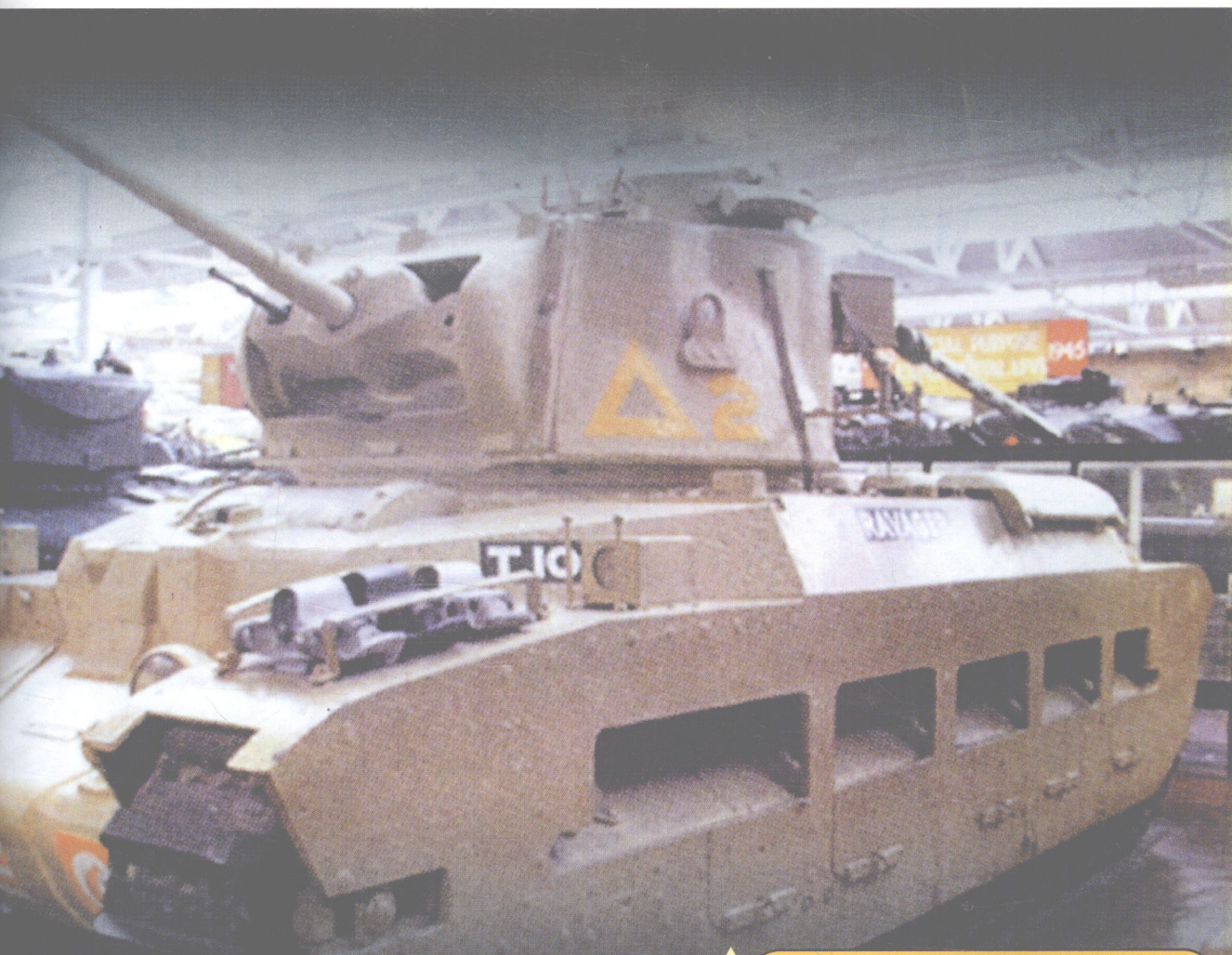
1939年开始装备部队的英国“马蒂尔达”Ⅱ型步兵坦克，战斗全重26.9吨，是首先采用炮塔液压驱动装置的坦克
