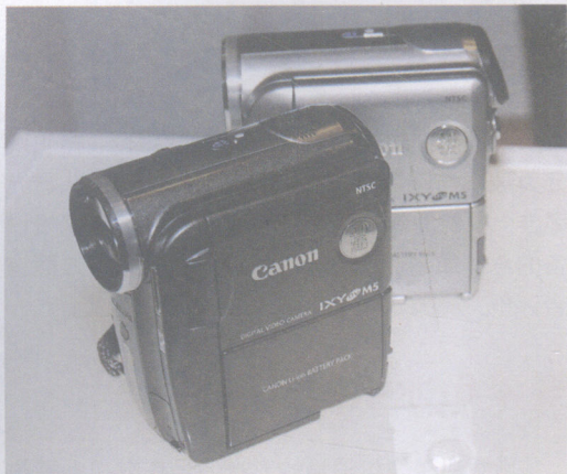
使用 CCD 作为感光元器件的数码摄像机
