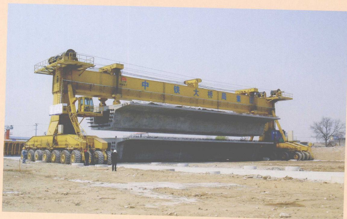
京津城际 7 号梁场 900 t 轮胎式吊运梁机
