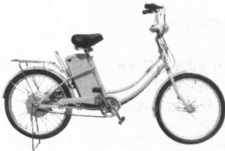
图 1-1 典型电动自行车示意图
