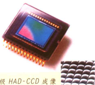
超级 HAD-CCD 成像 芯片上面有紧密相邻的 微小透镜，带来更好的感光度。
