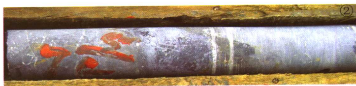
湖北清江水布垭工程趾板帷幕灌浆对比岩芯 (①灌前②灌后)
