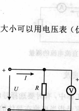
图 1.5 直流电压的测量
