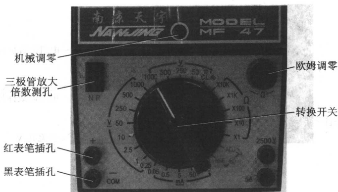
图 1-1-3 MF-47 型万用表操作面板
