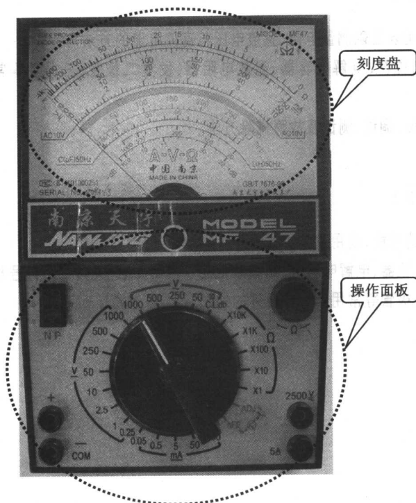
图 1-1-1 MF-47 型普通指针式万用表面板外观图
