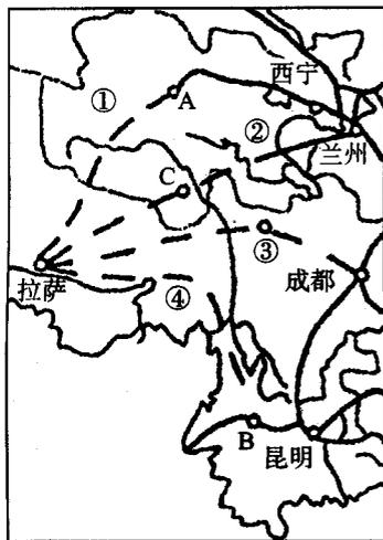
材料:青藏铁路是我国铁路网的重要组成部分,由青海省的省会西宁到西藏首府拉萨,全长1963千米。分两期修建:一期工程由西宁至青海省的格尔木(简称西格段),长约845千米,已于1984年通车;二期工程如下图所示,全长1118千米,它是海拔最高和线路最长的高原铁路。
