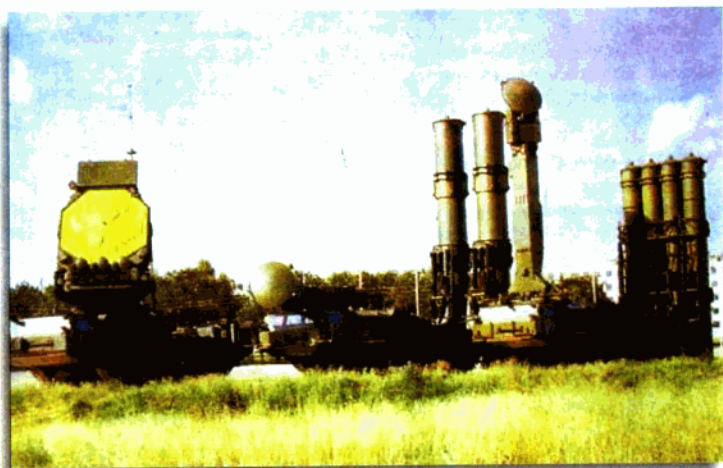
▲俄罗斯 S-300V 野战防空导弹系统（导弹在发射筒内，可与美国“爱国者”导弹抗衡）
