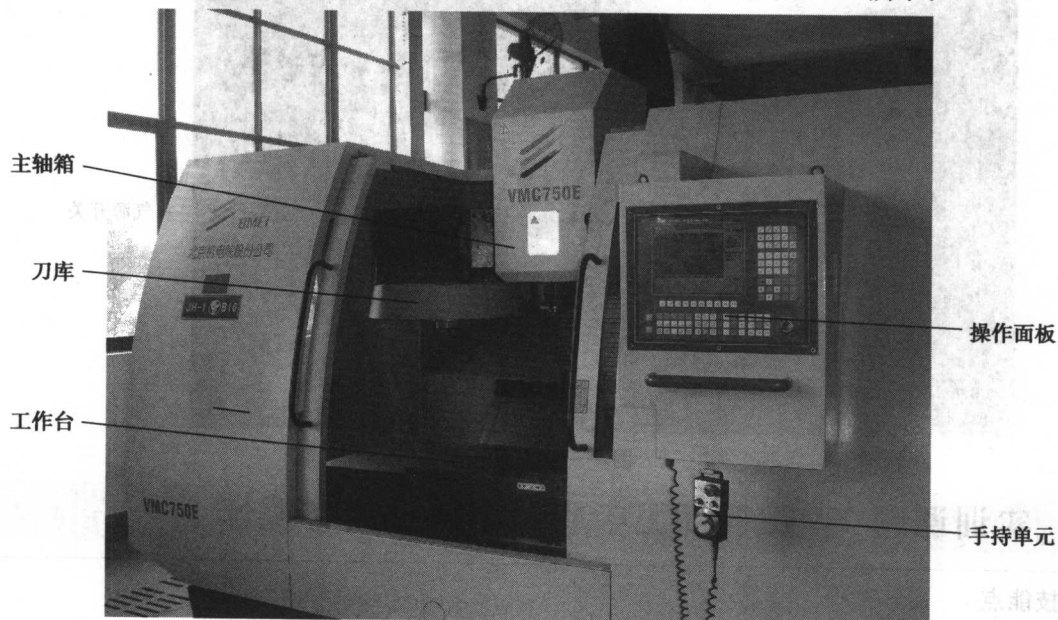
图 1—4 数控加工中心主要组成部分
