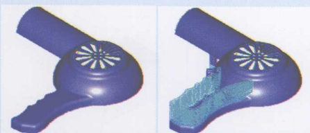
挖槽示例图与生成的刀具路径效果图
