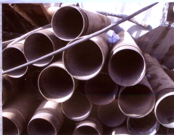
堆积体锚索造孔所用套管
