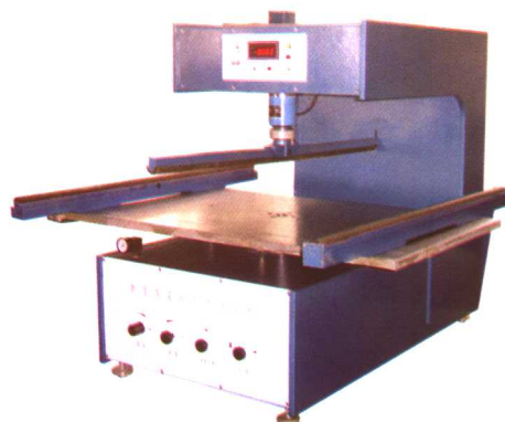
数显陶瓷砖抗折试验机
