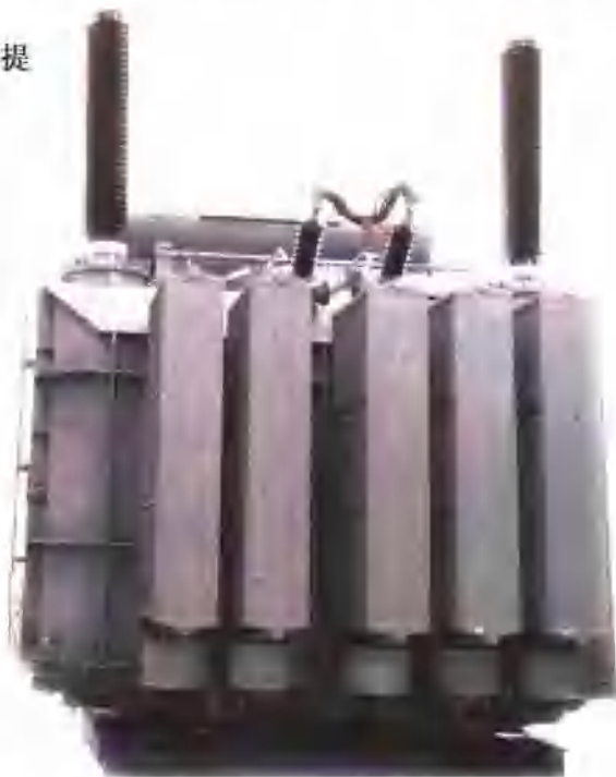
国家变压器质量监督检验中心试验的220KV单相牵引变压器
