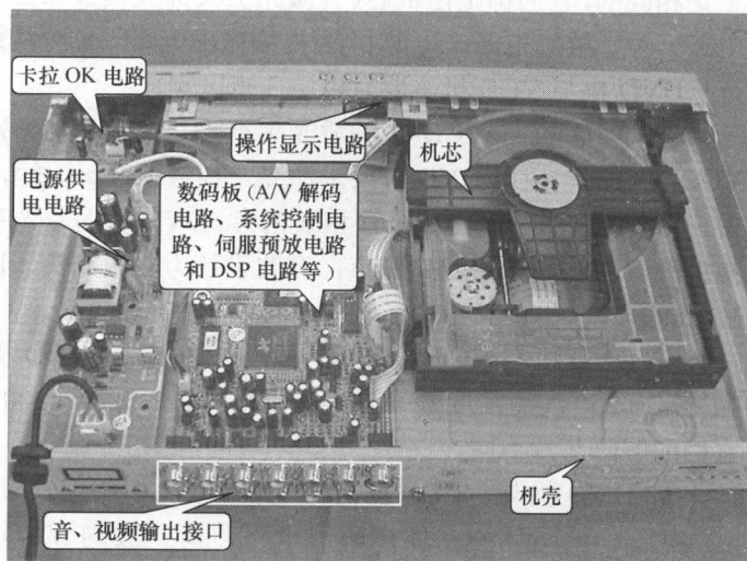
图 1-2 万利达 DVP-810 超薄型 DVD 机的整机结构图
