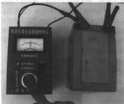
图1 蓄电池电压的测量
