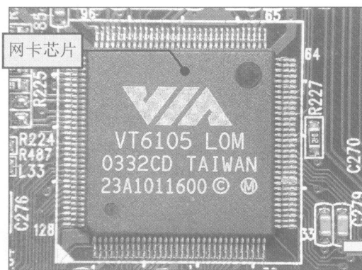
图 1-19 集成在主板上的网卡芯片
