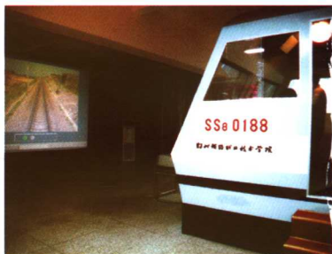
学院重视加强实训基地建设，自行研发出新型电力机车仿真模拟驾驶装置
