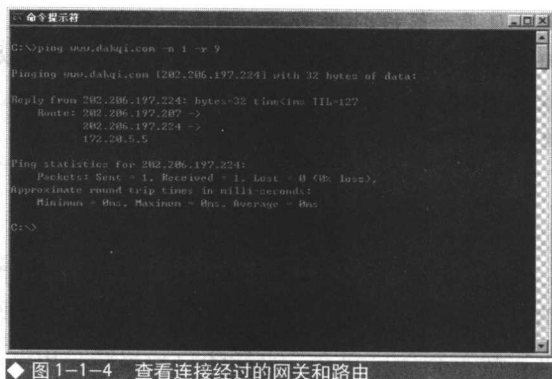
图 1-1-4 查看连接经过的网关和路由
