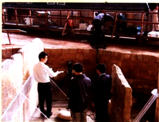
南越国宫署遗址调研现场X射线荧光分析 (文物本体表面无损元素分析)
