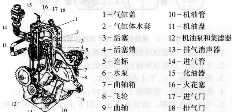
图 2-1 汽油发动机基本结构示意图
