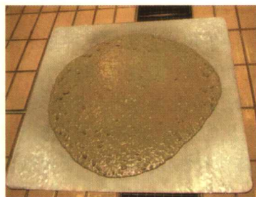
图7 以聚羧酸为基础的最新一代高效减水剂对水泥的依赖性
