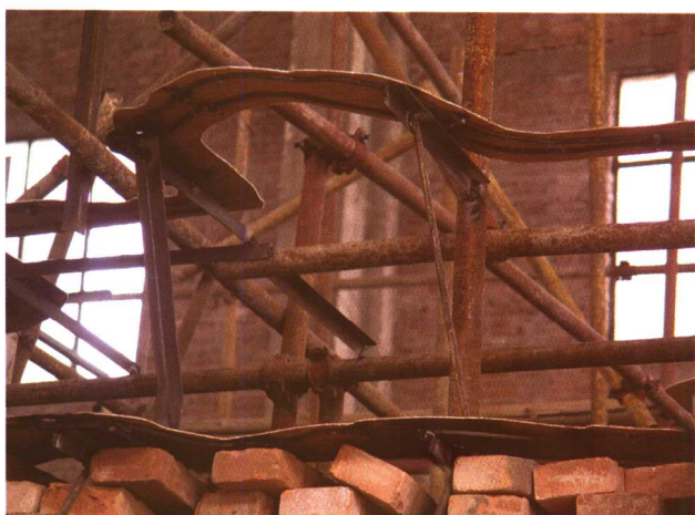
(h) 利用焊接点将原大形一层层固定
