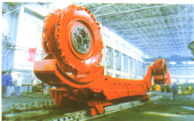
1985年太原矿山机器厂制造的AM-500双滚筒采煤机
