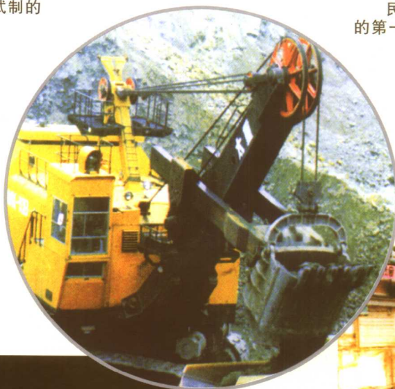
20世纪80年代太原重型机器厂自行研制的千万吨级露天 采掘设备WK—10B挖掘机
