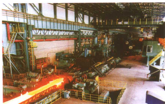
1994年投产的太原钢铁(集团)有限公司 1549毫米不锈钢热连轧生产线
