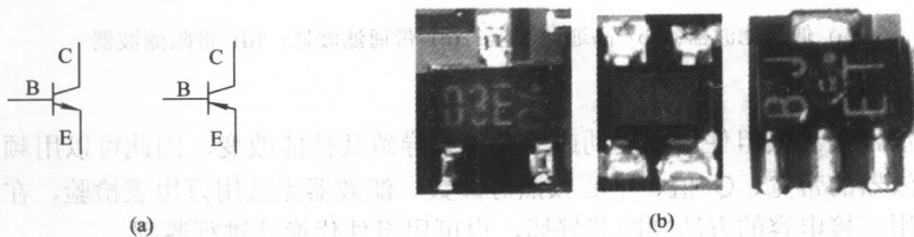
图 1-10 三极管的电路符号及实物图
