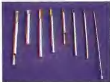
图 0-38 自制的天线刀具
