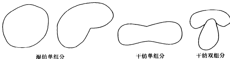
图 1-1 湿法和干法纺丝得到纤维的截面形状
