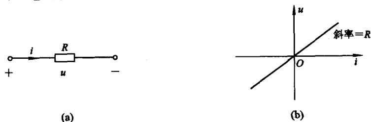
图 1-7 线性电阻的符号和伏安特性
