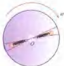
圆盘转动时，槽内的小球将向外移动，弹簧伸长。
