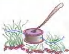
在高速转盘上有两根直径2 mm的尼龙绳，尼龙绳高速转动就成了一对割草飞刀。
