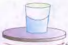
静止时杯中水面是平面，随圆盘转动后杯中水面就成了曲面。
