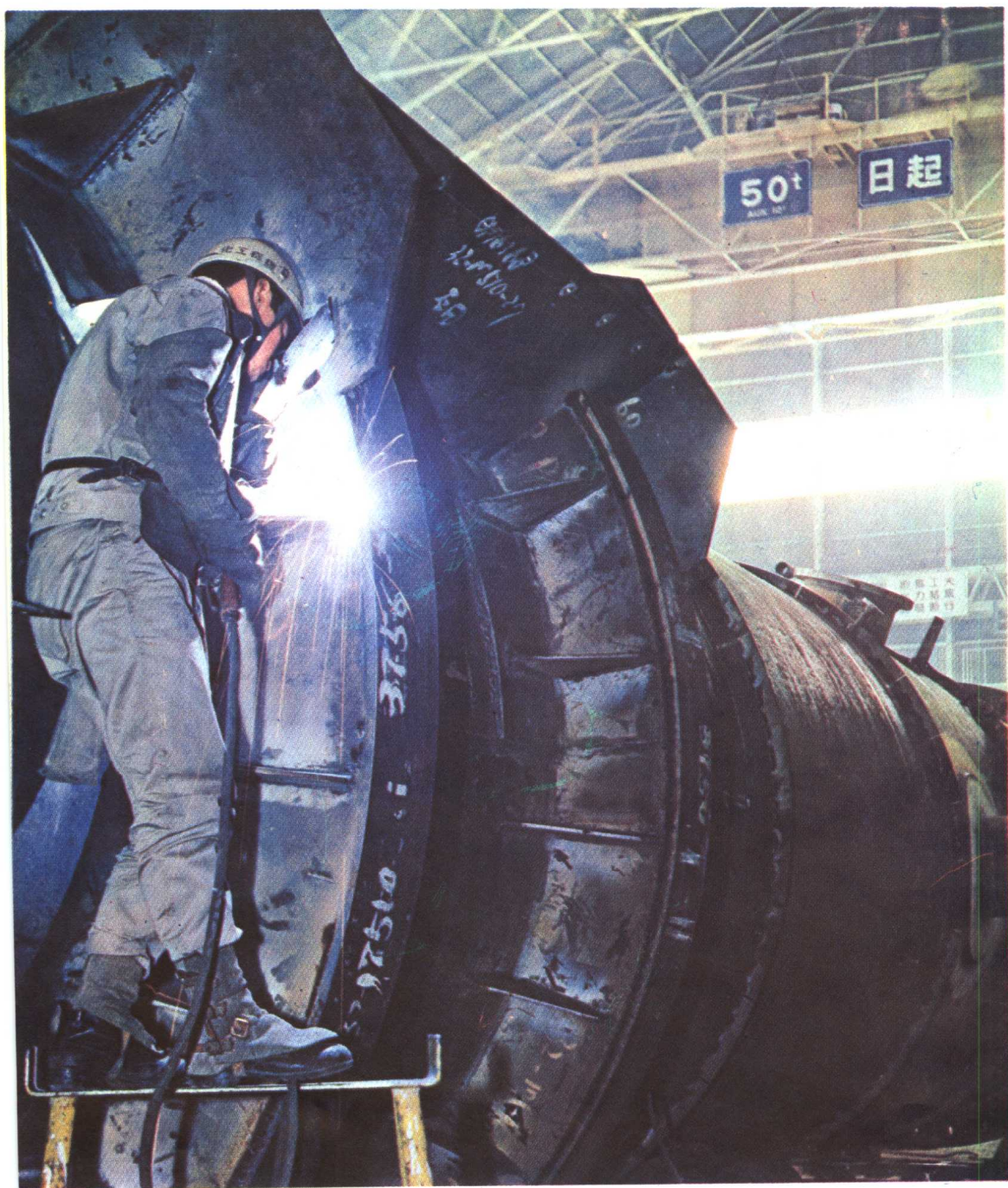
一般電弧焊接（如圖正在焊接船上鍋爐之配件）
