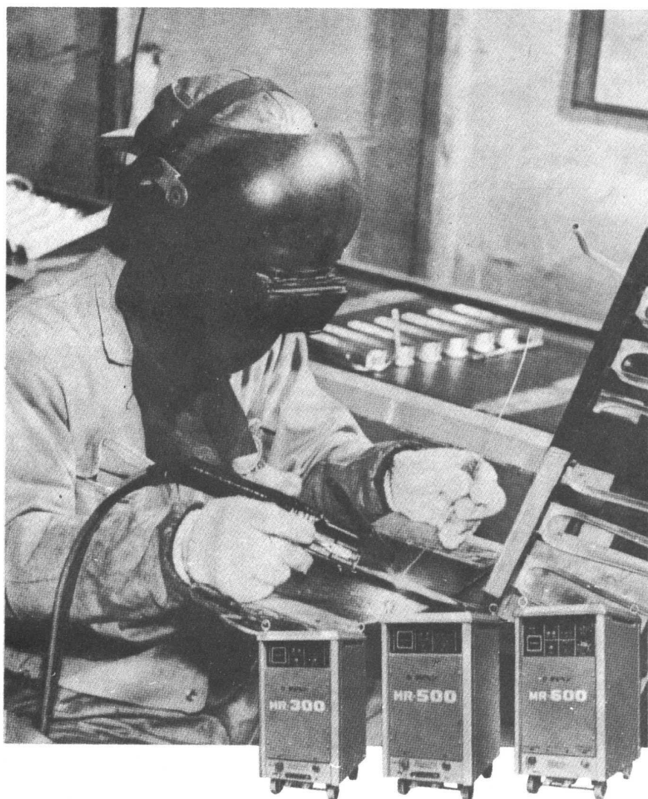
氫氣焊接操作情形
