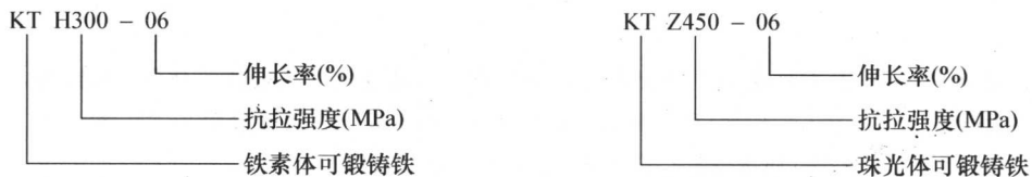
图 1-3 为铁素体可锻铸铁(白心可锻铸铁)；图 1-4 为珠光体可锻铸铁(黑心可锻铸铁)。
