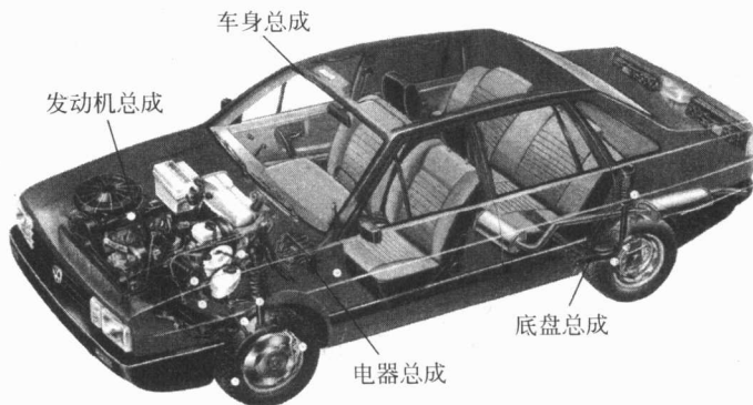
图 1.1 汽车总体构造图
