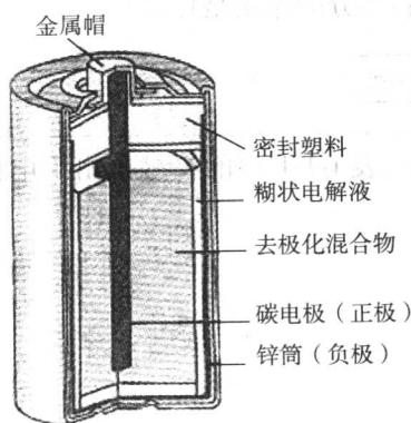
图 1-1-2 干电池内部结构
