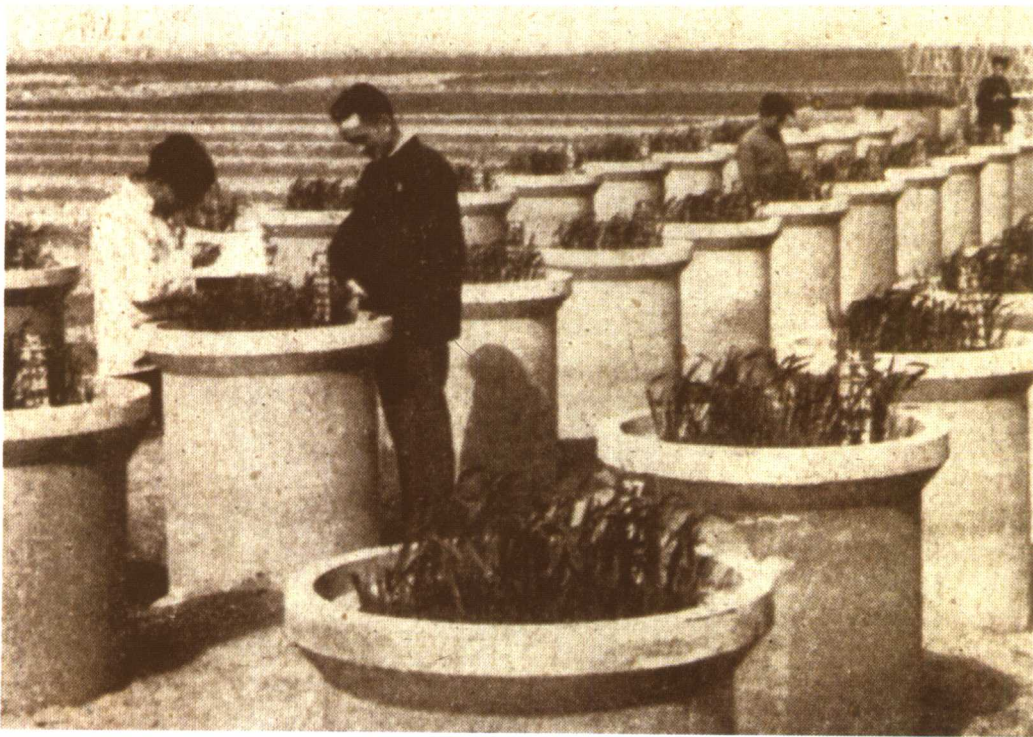
1953 年北淝河排涝灌溉试验——小麦耐淹试验
