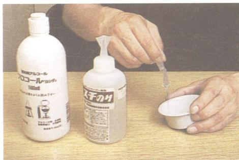
1. 先用工业级酒精充分稀释聚苯乙烯胶水(约3:1的比例),将稀释后的胶水吸入吸管。也可以用前端已被拉长的吸管吸取。此吸管开口要比速干胶吸管的直径要大些。
