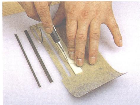
2. 在砂纸上放置直角形的材料，如ABS板或丙烯酸板，并使用切割工具将其切下。
