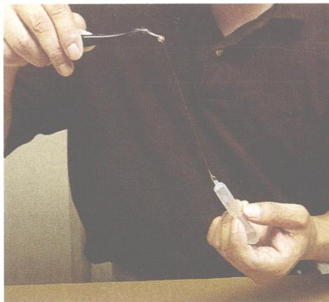
2. 用镊子钳迅速夹住并将吸管前端拉长。
