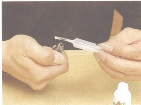
2. 用打火机将吸管前端加热并同时慢慢转动吸管使之逐步软化(请注意不要过度加热,否则容易引起燃烧)。
