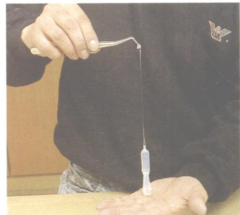
3. 用镊子钳夹起前端,并拉长吸管顶端,调整吸管的粗细及长度。
