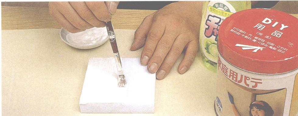
1. 将木工油灰泥和水以3:1—3:2的比例进行充分地混合，若无法溶合则将混合后的材料包裹好静置一夜，用刷子涂刷油灰泥遮蔽表面留下的印痕。若底层渗油或不溶合，加入一滴中性洗涤剂，这样就不会再出现排斥的现象。重复上述方法操作两次后，使之自然风干。
