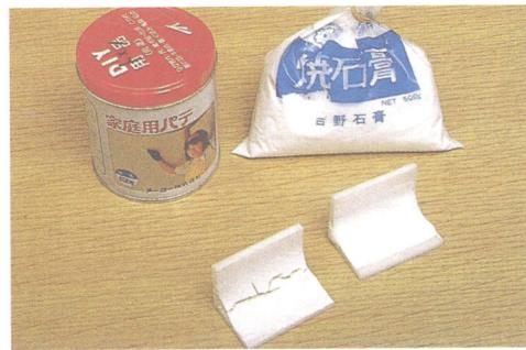
1. 若使用普通木料油灰泥，风干后会出现右图所示裂痕。如果将木料油灰泥用水充分稀释，再加入30%石膏充分混合（木料油灰泥与水的比例大约为3:2-3:3），这样油灰泥硬化的速度会比普通油灰泥要快，虽然制作起来比单纯用石膏要费时，但风干后坚若磐石且不会留下裂痕。
