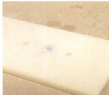
1. 若使用的材料与苯溶剂类油灰泥出现相排斥的情况（如ABS板或丙烯酸板），可用聚酯油灰泥填补小孔和划痕。加入2%~3%的硬化剂后充分混合，并用雕塑刀将其填入小孔之中。
