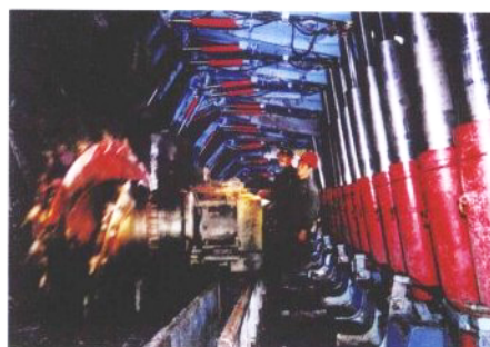
开发应用了具有自主知识产权的ZY6400-25/53型掩护式大采高综采成套设备
