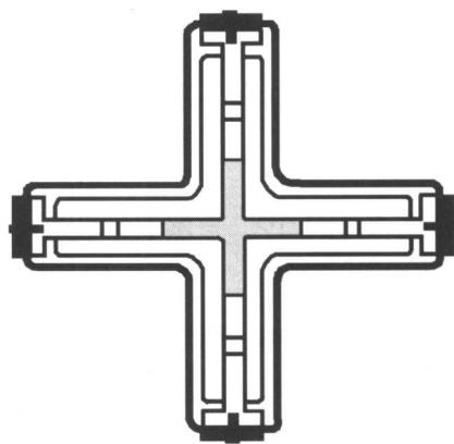
图2 巴塞罗纳馆立柱剖面图
