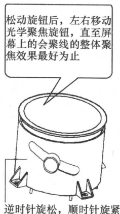
图 1-5 透镜聚焦调整示意图
